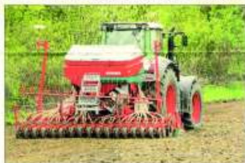
Die Drillkombi lockert den Boden auf, verlegt ihn in 32 parallel verlaufenden Reihen und bringt die Samen in die richtige Tiefe.
